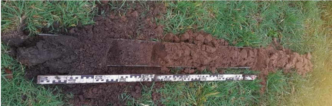
Afbeelding 14: Foto van het boorprofiel van boring 2 met v.l.n.r. de donkerbruin bouwvoor, de bruine eerdlaag, het lichtbruine plaggendeek en het fijne gele dekzand.
